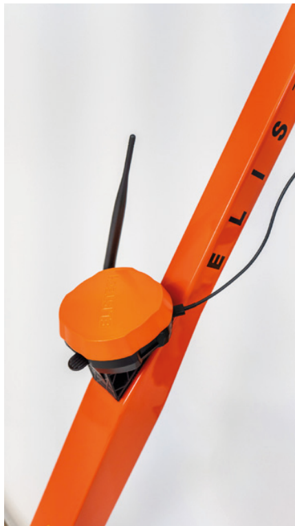
GPS ровър (подвижна приемателна станция в система за спътниково позициониране с висока точност)
