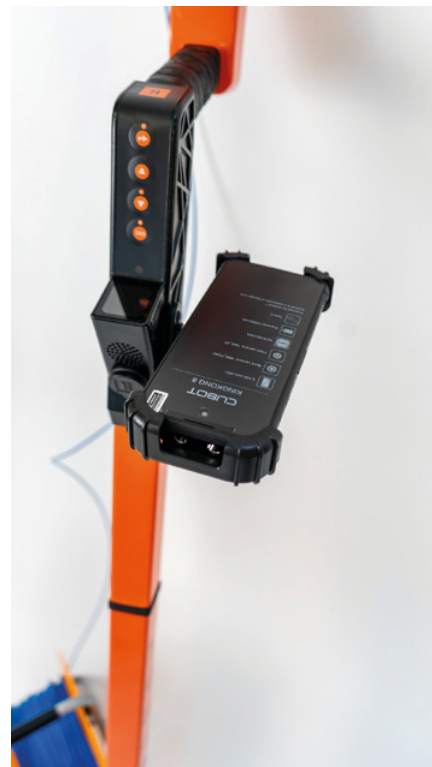
GPS ровър (подвижна приемателна станция в система за спътниково позициониране с висока точност)
